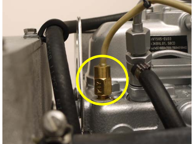
Fig. 4.4.5-2: Thermosensor am Abgaskrümmer
