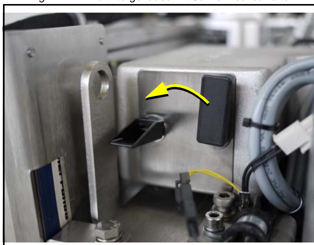
Fig. 7.7.1-2: Luftfiltergehäuse mit Schnellwechselhalter
