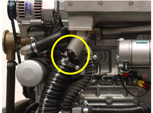
Fig. 4.4.5-2: Thermosensor am Abgaskrümmer
