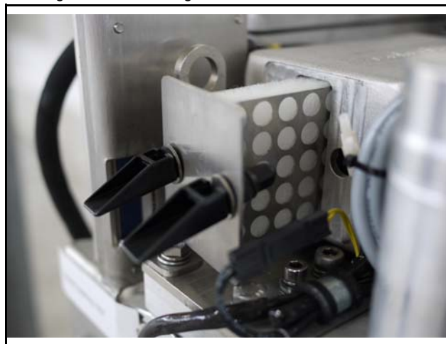
Fig. 7.7.1-3: Luftfiltergehäuse mit Schnellwechselhalter
