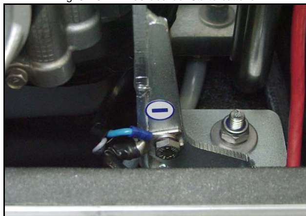
Fig. 5.7.3-4: Minuskabel der Starterbatterie
