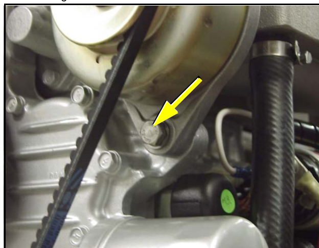
Fig. 7.13-2: Schraube unter der Lichtmaschine
