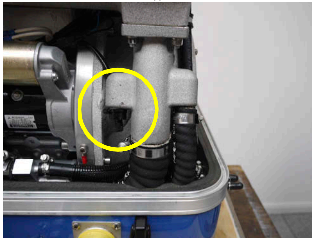
Fig. E.3.6-2: Thermosonde sur le collecteur de gaz d'échappement
