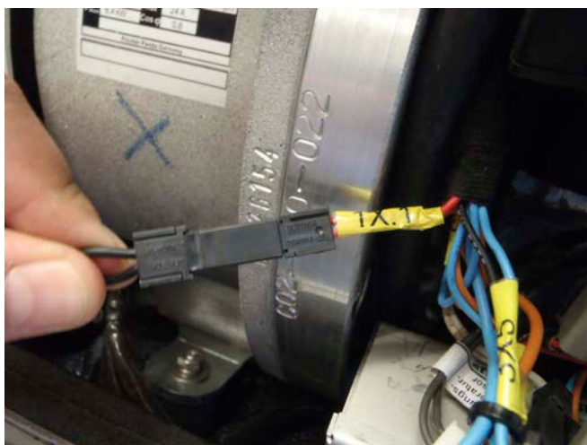
Fig. K.5-1: Pont d'arrêt d'urgence dans le faisceau de câbles
