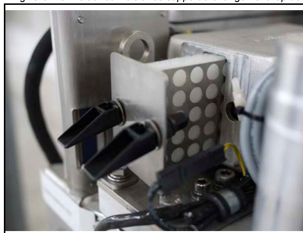
Fig. G.9.1-3: Boîtier du filtre avec support à changement rapide
