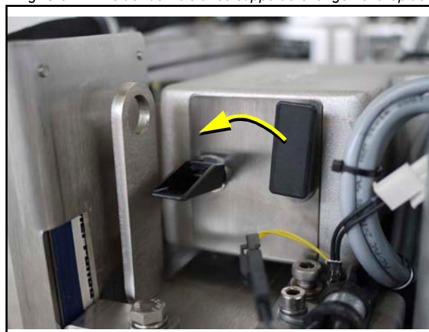
Fig. G.9.1-3: Boîtier du filtre avec support à changement rapide
