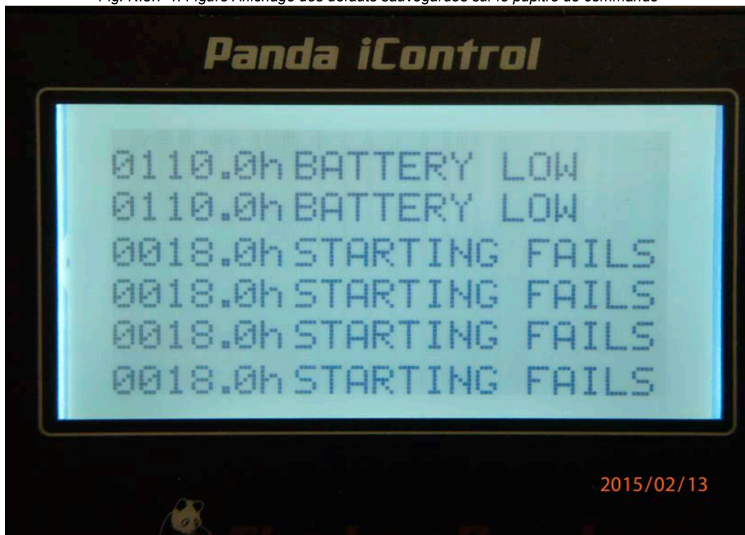
Fig. N.3.7-1: Figure Affichage des défauts sauvegardés sur le pupitre de commande
