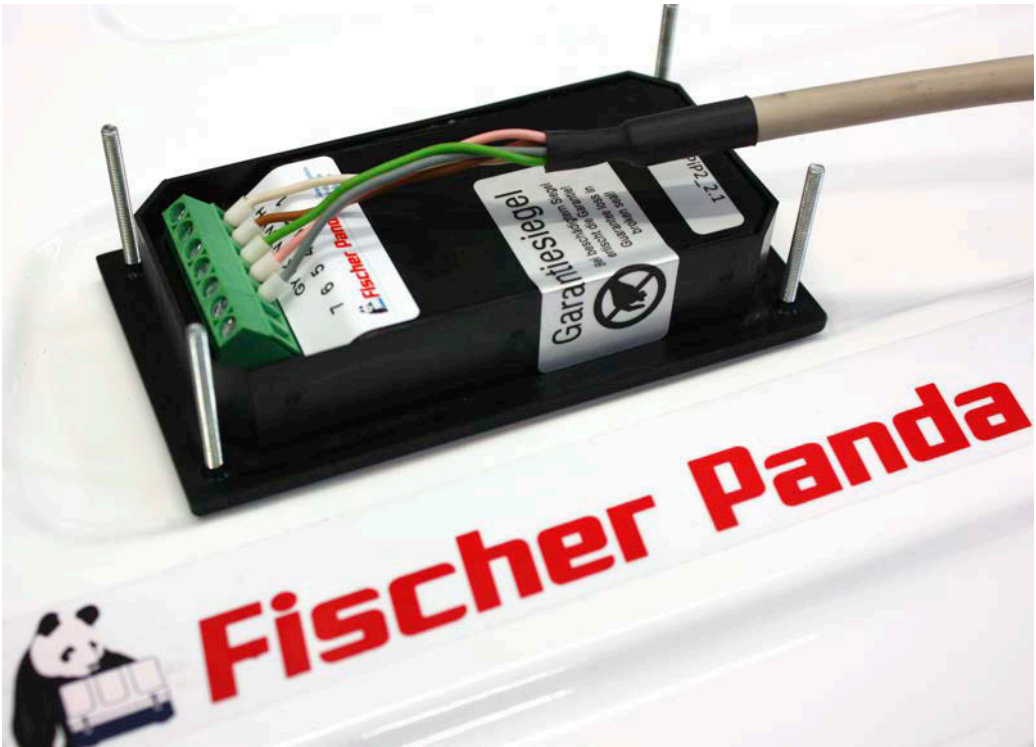
Fig. L.2.1-1: Platine iControl2 Panda avec câble de raccordement et boîtier fermé
