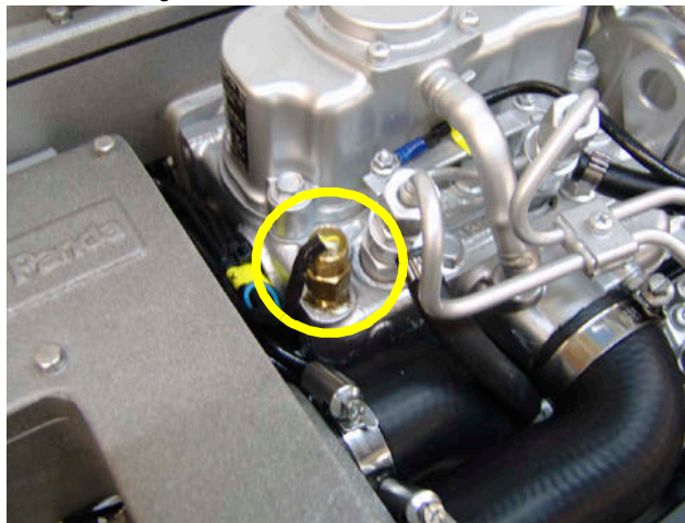
Fig. E.3.6-1: Thermosonde sur le moteur
