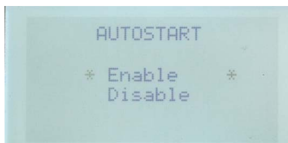
Fig. 2.4.6-2: “Autostart”（自动启动）子菜单
