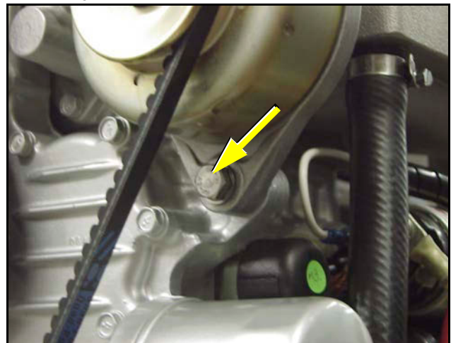
Fig. 10.13-2: Schraube unter der Lichtmaschine
