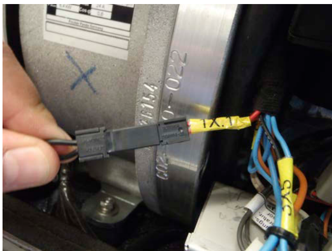
Fig. 15.5-1: Not Stop Brücke im Kabelbaum
