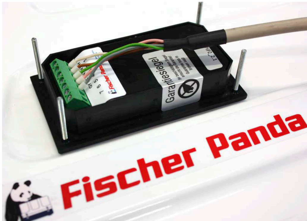
Fig. 16.2.1-1: Panda iControl2-Panel mit Panel-Anschlusskabel und geschlossenem Gehäuse
