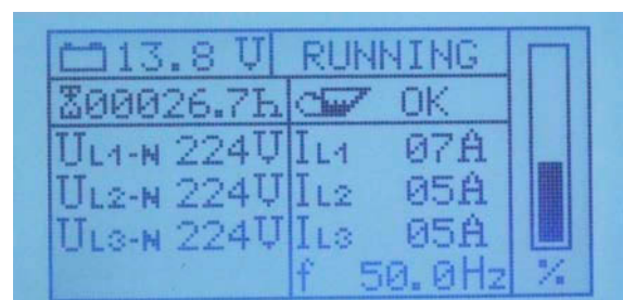
Fig. 15.3.3.4-3: Inverterseite Strangspannungen und Leiterströme
