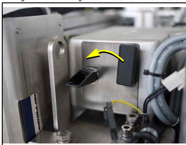
Fig. 10.7.1-2: Luftfiltergehäuse mit Schnellwechselhalter
