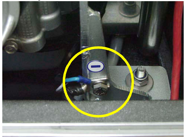
Fig. 8.10.3-4: Minuskabel der Starterbatterie
