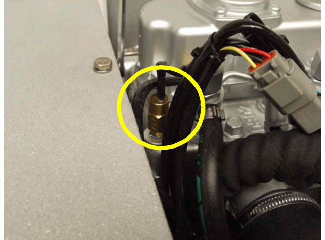
Fig. 7.3.6-1: Thermoschalter am Motor
