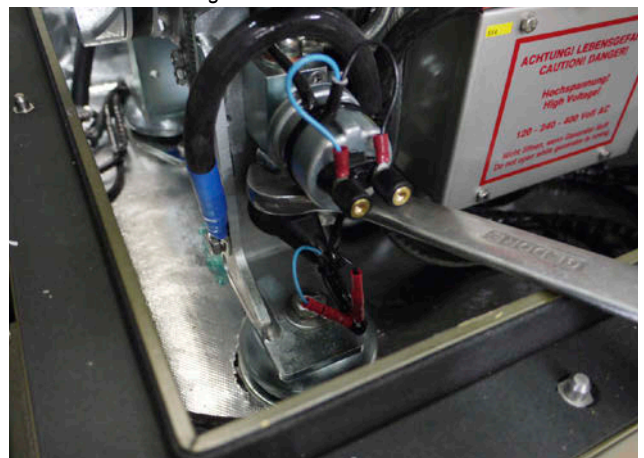
Fig. F.21-2: Pressostat huile
