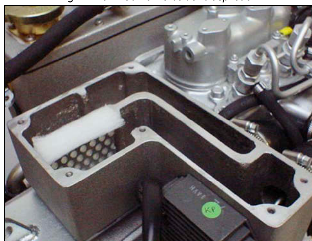
Fig. F.11.0-2: Ouvrez le boîtier d'aspiration.
