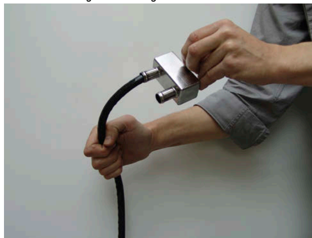
Fig. F.8-2: Lavage à contre-courant
