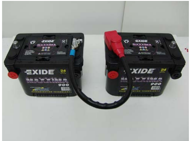
Fig. 5.8.4.1-3: Installation batterie de démarrage de 24V
