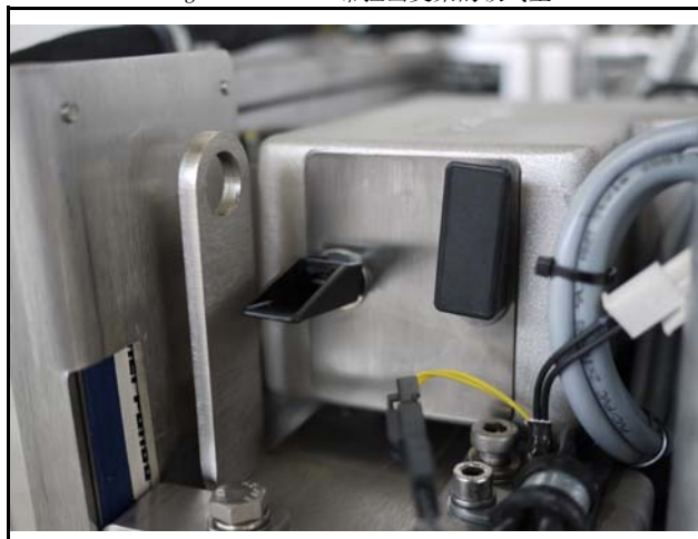
Fig. 7.11.2-2: 带拉出支架的吸气室
