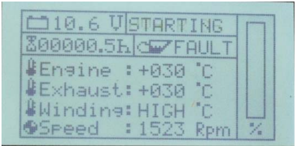
Fig. 14.1.1-2: 警告： „ 绕组温度过高 “
