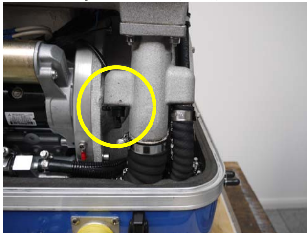
Fig. 4.2.6-2: 排气歧管温度传感器
