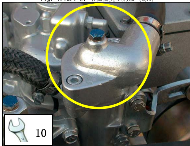
Fig. 7.12.1-3: 节温器壳上的放气螺钉
