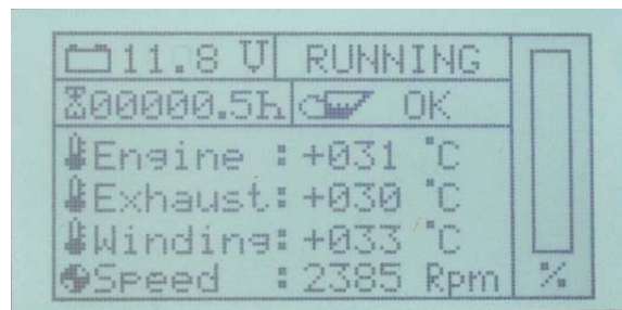
Fig. 12.3.3.4-1: Standard-Displayseite während des Operation-Modus
