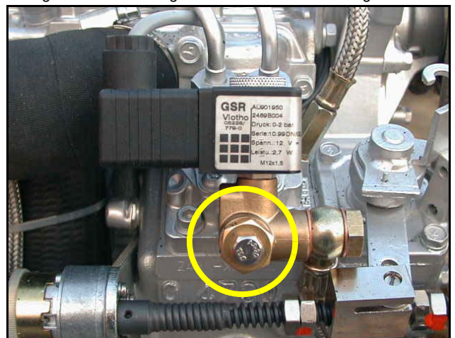
Fig. 7.10-2: Entlüftungsschraube am Kraftstoff-Magnetventil
