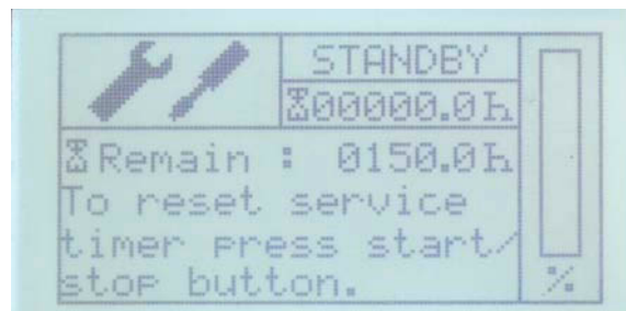
Fig. 11.4.7-1: Remise à zéro du temps jusqu'à la prochaine
