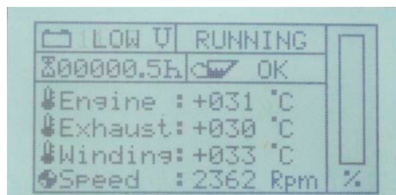
Fig. 14.1.1-1: Mise en garde "Tension d'alimentation trop faible"
