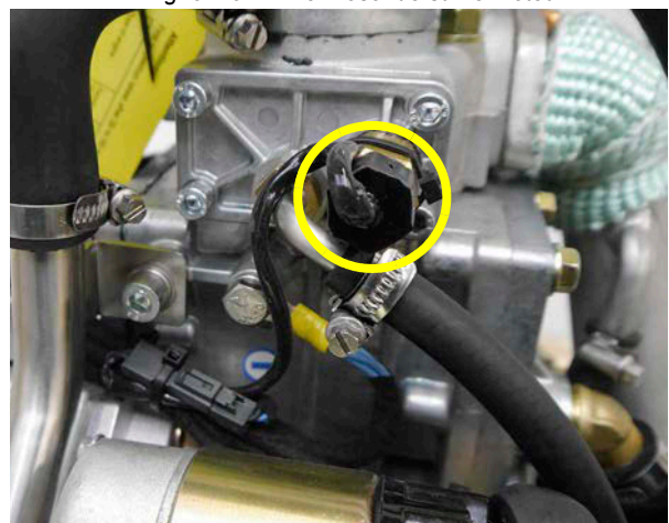
Fig. 5.4.5-1: Thermosonde sur le moteur
