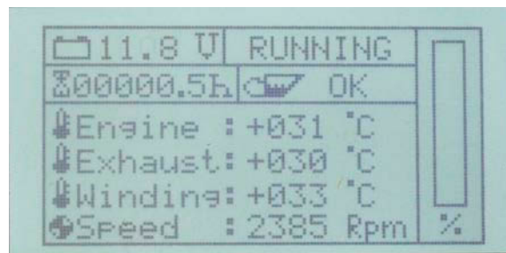
Fig. 11.3.3.4-1: Page standard de l'écran pendant le mode opérationnel
