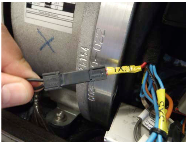
Fig. 11.5-1: Pont d'arrêt d'urgence dans le faisceau de câbles
