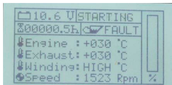
Fig. 14.1.1-2: Mise en garde "Température bobine trop élevée"
