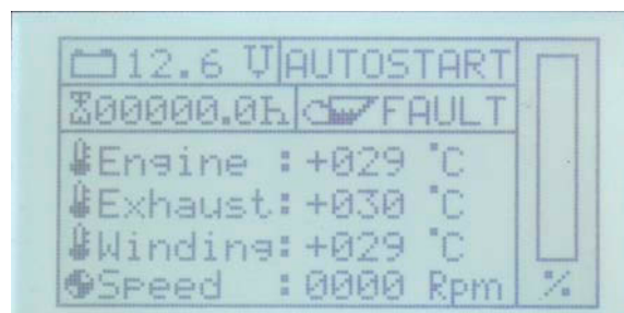
Fig. 11.3.3.7-1: Page standard de l'écran en mode Autostart
