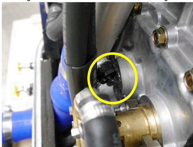
Fig. 5.4.5-2: Thermosonde sur le le collecteur de gaz
