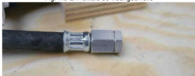
Fig. 7.9-2: Flexible de vidange d'huile
