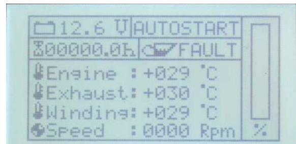
Fig. 11.4.6-7: Page standard de l'écran en mode Autostart
