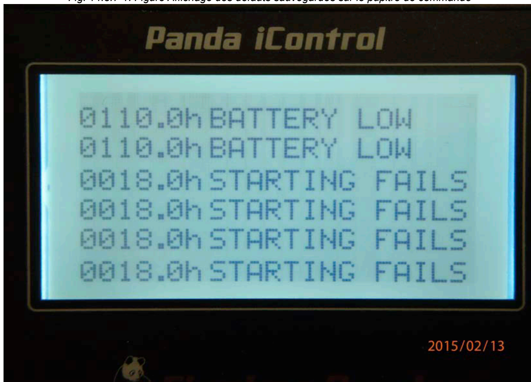
Fig. 14.3.7-1: Figure Affichage des défauts sauvegardés sur le pupitre de commande
