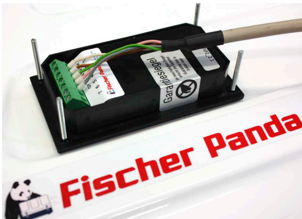
Fig. 12.2.1-1: Platine iControl2 Panda avec câble de raccordement et boîtier fermé
