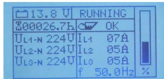
Fig. 11.3.3.4-3: Page onduleur Tensions par phase d'enroulement et courants par conducteur
