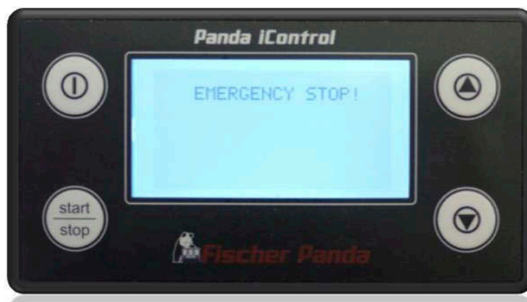
Fig. 11.5-2: Platine Affichage arrêt d'urgence
