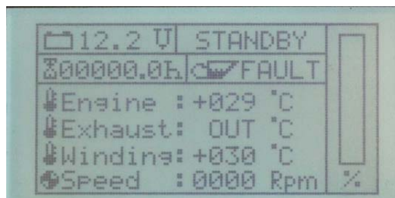
Fig. 15.2-2: Défaut „STARTING FAILS“, la procédure de démarrage n'a pas eu de succès
