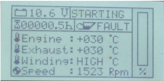
Fig. 15.1.1-2: Mise en garde "température bobinage trop élevée"
