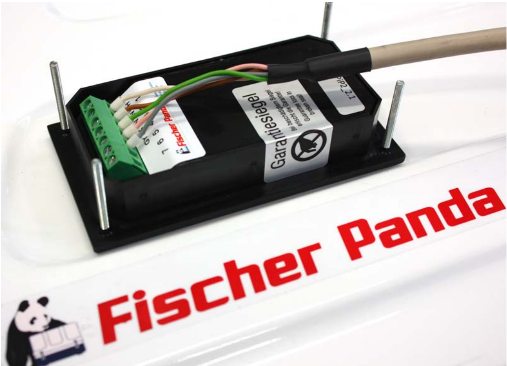
Fig. L.2.1-1: Platine de Panda iControl2 avec le câble de raccordement et boîtier fermé
