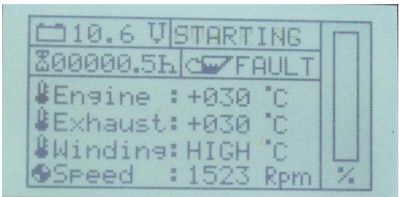
Fig. N.1.1-2: Mise en garde "température bobinage trop élevée"
